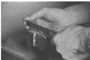
6 Für den genauen Sitz der Feder wird mit einer Schlüsselfeile eine Vertiefung in den Flansch des neuen Bremsbolzens gefeilt
